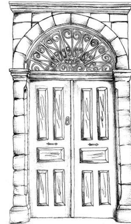
2.Νταμπλαδωτή εξώθυρα με τοξωτό υπέρθυρο, πελεκητή πέτρα και σιδεριές φεγγίτη.
