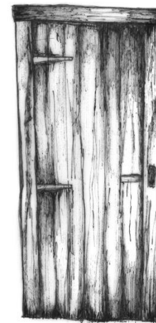
2.Σανιδωτή μονόφυλλη στενόμακρη εξώθυρα(εσωτερική όψη).
